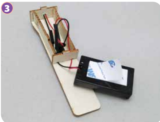
Dán băng dính hai mặt vào đáy hộp pin
